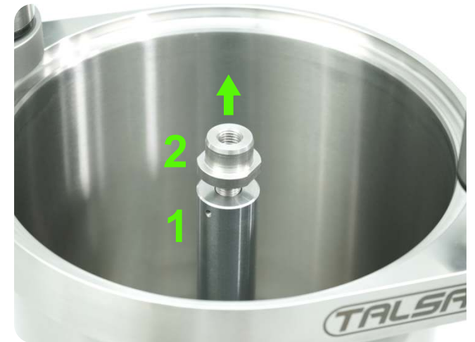
Vérin du cylindre hydraulique en acier inoxydable. Partie supérieure du vérin remplaçable.
