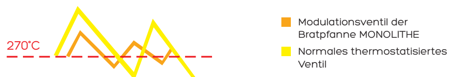
Wirkung der Leistungsmodulation
