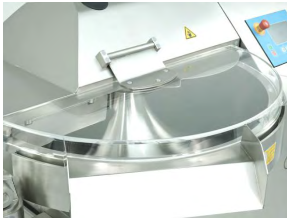
Couvercle anti-bruit rabattable avec ralentissement automatique de la vitesse des couteaux.
