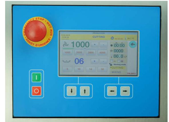
Écran numérique de contrôle et de programmation pour toutes les fonctions de la cutter.
