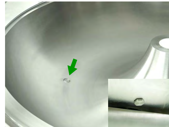
Cuve avec système de vidange .
