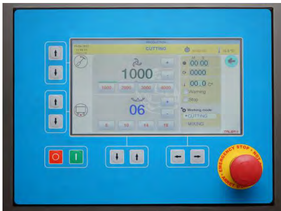
Bedienfeld mit großem 10" Touchscreen und Folientastatur zur Kontrolle aller wichtigen Funktionen.
