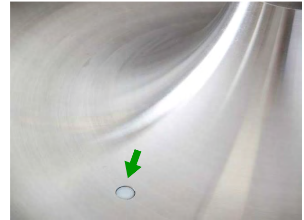
Ablaßschraube am Schüsselboden erleichtert die Reinigung.
