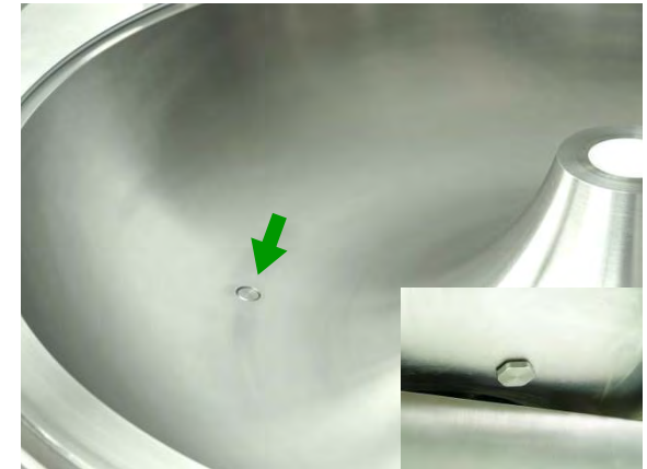
Ablaßschraube im Schüsselboden mit automatischer Positionierung.
