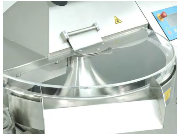
Transparenter Lärmschutzdeckel mit automatischer Reduzierung der Messergeschwindigkeit beim Öffnen.
