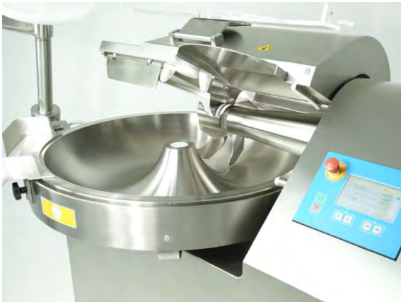
Motorisierte Messerabdeckung aus rostfreiem Edelstahl.
