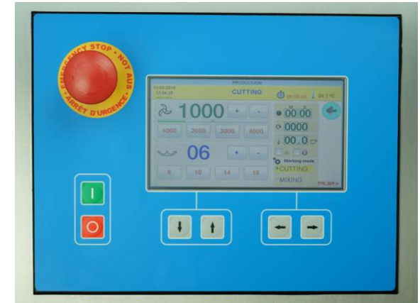
Bedienfeld mit großem 7" Touchscreen und Folientastatur zur Kontrolle aller wichtigen Funktionen.
