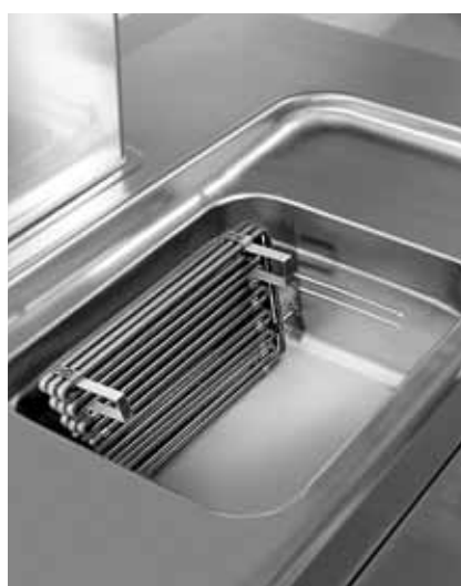
Kippbare Heizelemente beim Elektromodell.
