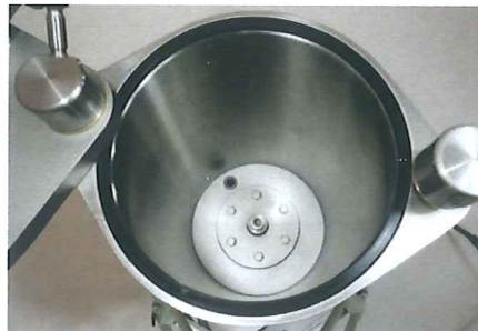
Luft- / Spülwasserauslauf im Boden
